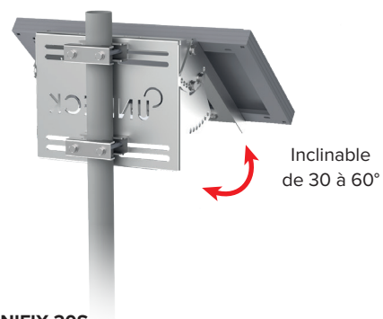
UNIFIX 20S Pour Unisun 10.12M/ 10.24M/ 20.12M/ 20.24M Orientation paysage Tête et milieu de mât Brides de fixation en option Ref 0286
