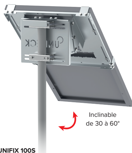
UNIFIX 100S Pour Unisun 80.12M/ 100.12M/ 100.24M/ 120.12BC Orientation paysage ou portrait Tête et milieu de mât Brides de fixation en option Ref 0323
