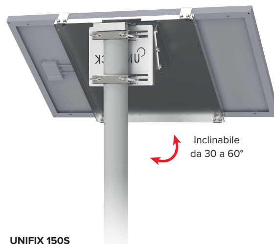
UNIFIX 150S Per Unisun 150.12M/ 150.24M/ 150.12BC Orientamento orizzontale o verticale Cima e parte centrale del palo Flange di fissaggio opzionale Ref 0866
