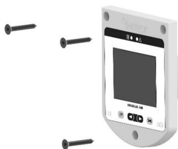
❷ Posizionare l'Unisolar al posto precedentemente forato poi avvitare con 3 viti adatte al muro (viti non fornite)
