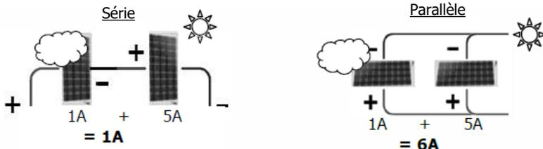
Dans le cas d'un couplage parallèle, l'intensité des panneaux s'additionne
