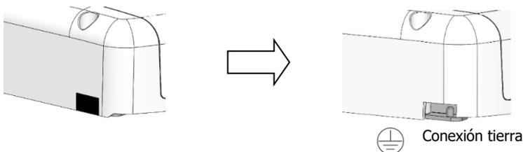
Panel fotovoltaico : Los terminales positivo y negativo de la conexión panel no deben estar conectados a la tierra. Conecte únicamente el marco de los paneles a la tierra para reducir el impacto de rayos.
