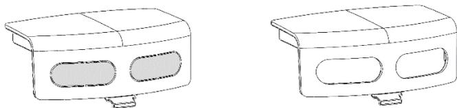
Pase los cables a través de los dos orificios hasta el regulador de carga. Por fin, posicione la tapa de protección.
