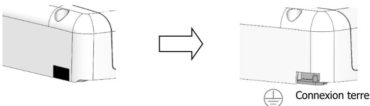
Panneau photovoltaïque : Les pôles positif et négatif de la connexion panneau ne doivent pas être reliés à la terre. Reliez uniquement le cadre de vos panneaux photovoltaïques à la terre pour réduire l'impact de foudre. Classe de protection: Pour UNIMPPT 100/30.24L et 100/40.24L, la tension à vide ( $V_{oc}$ ) est supérieure à 75V (sur toute l'étendue de la plage de température), l'intégralité du système solaire doit être installé selon la classe de protection II.
