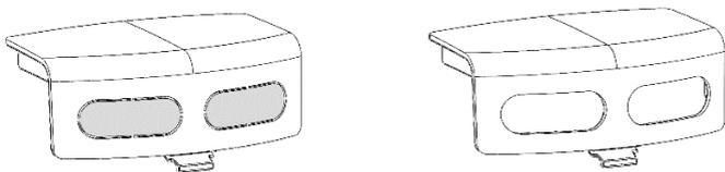
Passer les câbles à travers les deux orifices jusqu'au régulateur de charge. Enfin, positionner le couvercle de protection.
