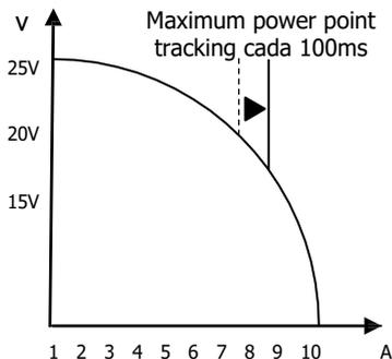
UNIMPPT garantiza así el máximo de potencia incluso en condiciones climáticas de los más cambiantes (cielo nublado).
