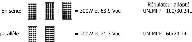
Uniteck recommande la connexion en parallèle pour un rendement électrique supérieur et pour éviter toute perte due aux ombrages.
