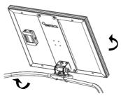
Si installano su tutti i balconi o corrimano a forma cilindrica con un diametro di 20 a 45 mm (lunghezza minima del tubo : 130 mm).
