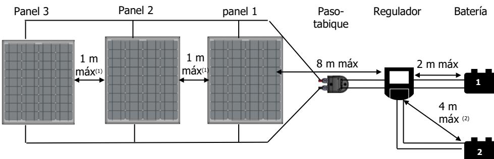
(1) Posibilidad de alargar la distancia entre los paneles de un metro suplementario por añadir un Unicable 612B y 612 R (cables no provistos con los kits Uniconnect).
